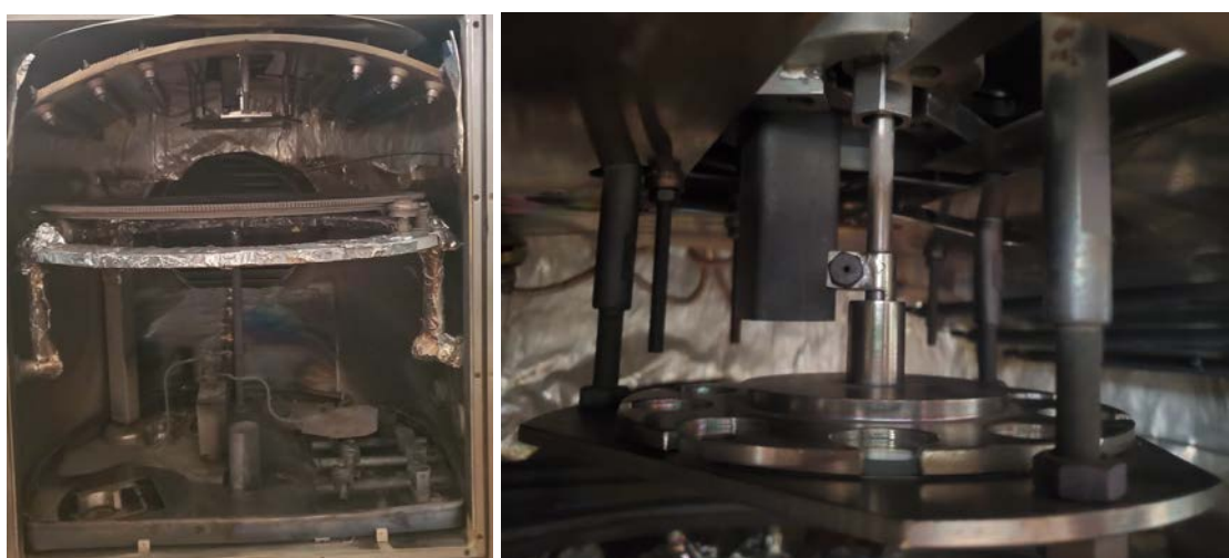
Рис. 1. Внутренняя часть камеры ВУ-1(слева) и блок свидетелей, крупно (справа).
