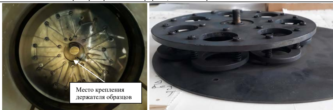
Рис. 2. Внутренняя часть камеры УРМЗ: вид снизу (слева) и блок свидетелей, крупно (справа).
