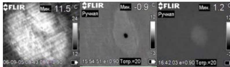
Рис. 3. Внешний вид проявления дефектов подземного трубопровода на поверхности в инфракрасном диапазоне [6].
