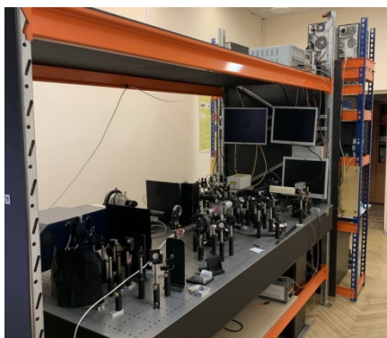
Рис. 1. Фотография установки лазерного нагрева веществ в ячейках высокого давления.
